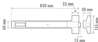
Ajustable para diferentes anchos de puertas. Acción horizontal de toque de un punto. Picaporte de acción precisa en caso de emergencias.
