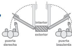
El sentido de apertura de las puertas se determina situándose en la parte exterior de la habitación de frente a la puerta y observando la posición de las bisagras, si las bisagras están colocadas en el lado derecho la puerta es derecha, mientras que si están colocadas en el lado izquierdo, será puerta izquierda.
